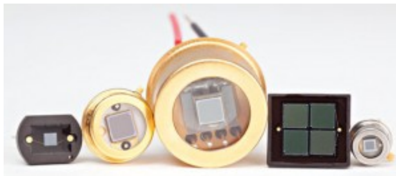
Рисунок 68 - Внешний вид различных детекторов SiPM.
