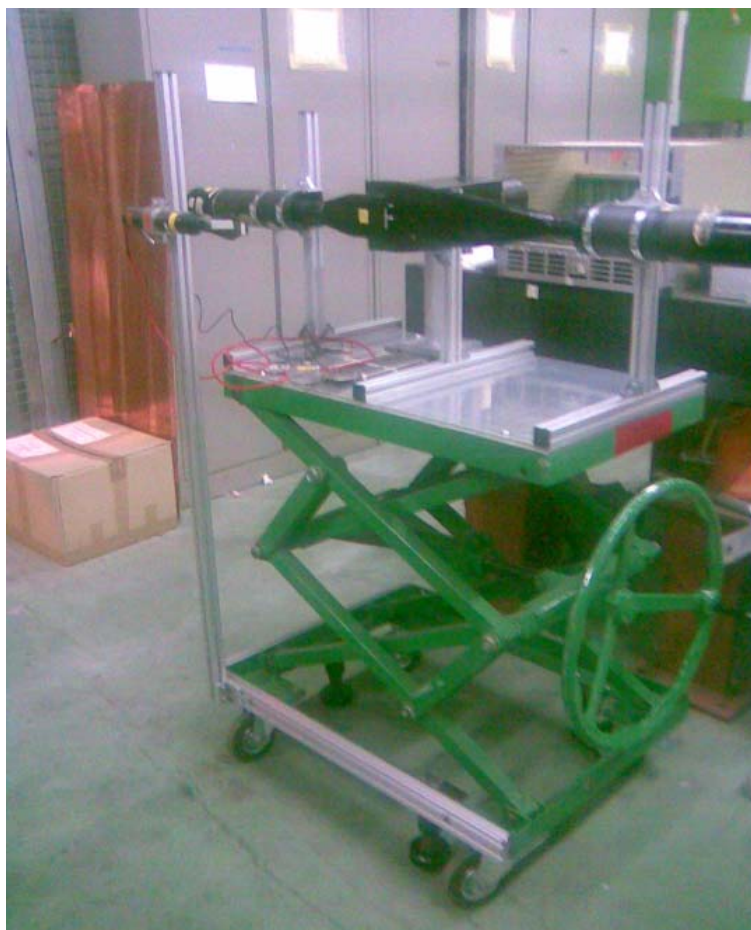
Рисунок 65 - Платформа с детекторами системы идентификации частиц.
